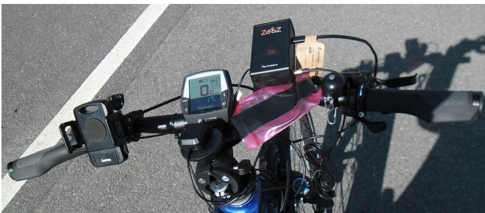
Bild 25. Befestigung des ZooZ Geräts und Position der GNSS-Antenne
