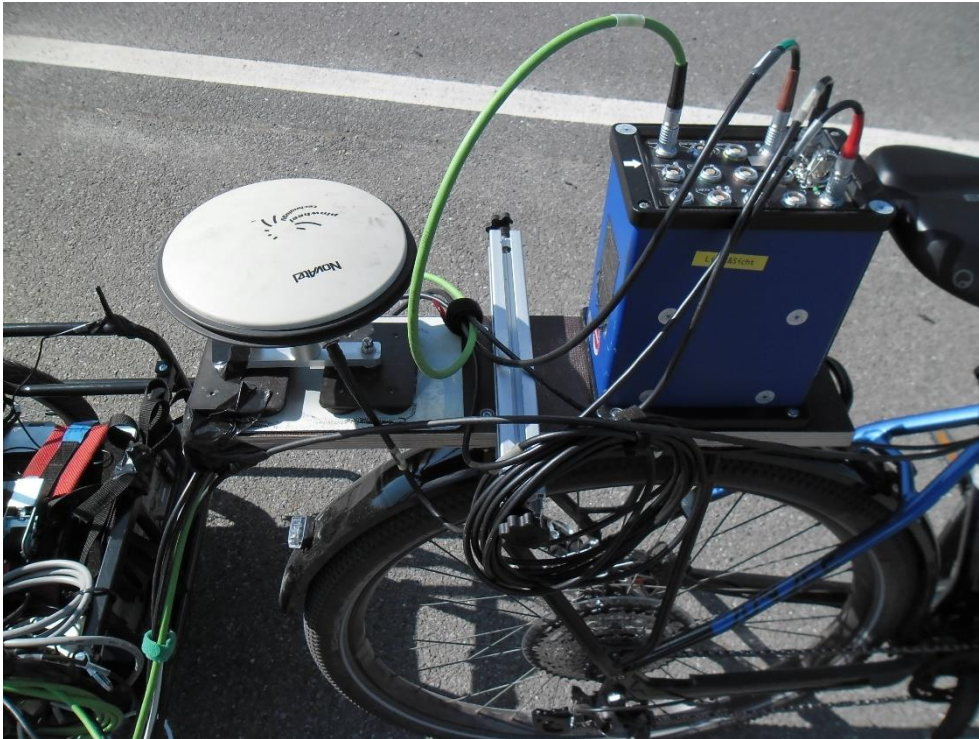
Bild 26. ADMA und GNSS-Antenne am Fahrrad
