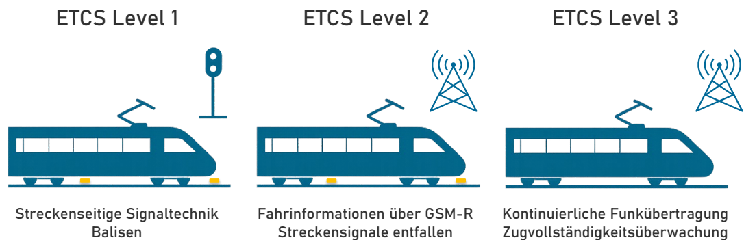
Abb. 1 Überblick ETCS-Level in Anlehnung an [3]
