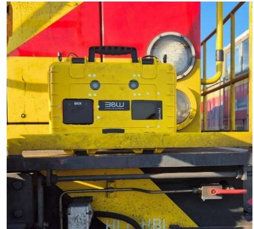
SAMIRAmobil mit RADAR, LiDAR, Stereo-Kamera, GNSS und 5G-Datenübertragung
