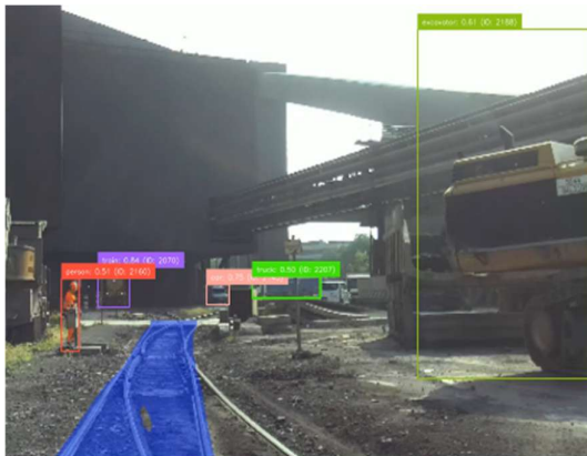
Augmentierter Videostream im Führerhaus für den Tf
